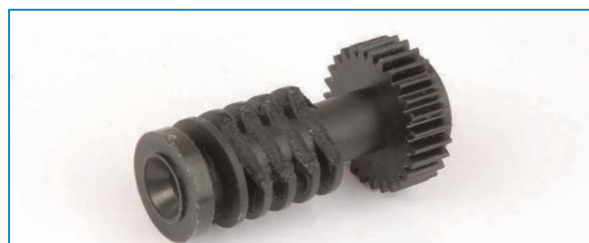
Usterka przekładni ślimakowej na skutek ograniczonego ruchu mechanizmu VNT.
