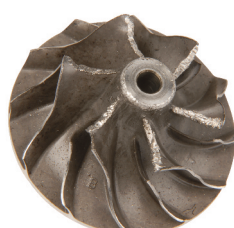
Uszkodzenie łopatek koła kompresji lub wałka
