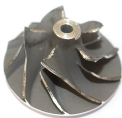
Wyszczerbienia na łopatkach koła kompresji
