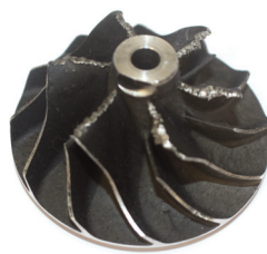
Wżery na łopatkach koła kompresji
