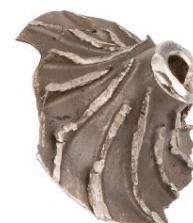
Rozerwanie koła kompresji
