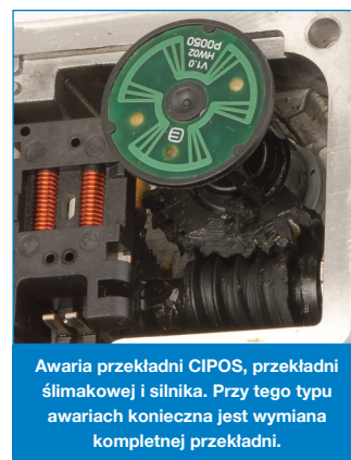
Awaria przekładni ślimakowej spowodowana ograniczeniem działania mechanizmu VNT
