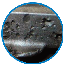
Wżery na łopatkach geometrii
