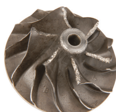
Uszkodzenia łopatek wirnika sprężarki i turbiny
